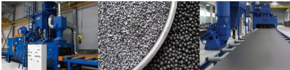
**В ПРОЦЕССЕ ДРОБЕСТРУЙНОЙ ОБРАБОТКИ ПОВЕРХНОСТЬ ПРУЖИНЫ БОМБАРДИРУЕТСЯ МИЛЛИОНАМИ КРОШЕЧНЫХ СТАЛЬНЫХ ШАРИКОВ**
